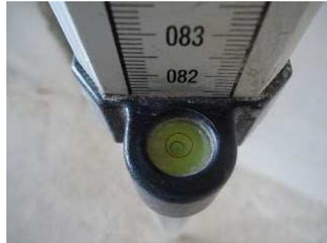
Nível de bolha acoplado a uma régua
